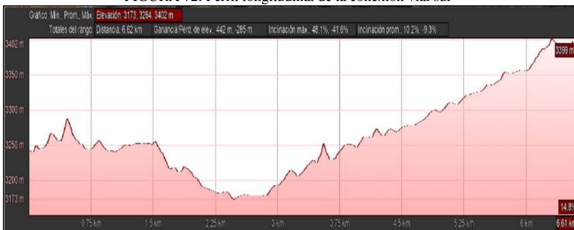
FIGURA 72: Perfil longitudinal de la conexión vial sur
