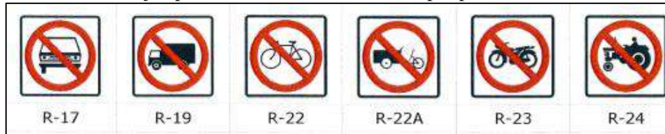
FIGURA 240: Ejemplos de Señales de Prohibición por paso de clase de vehículo
