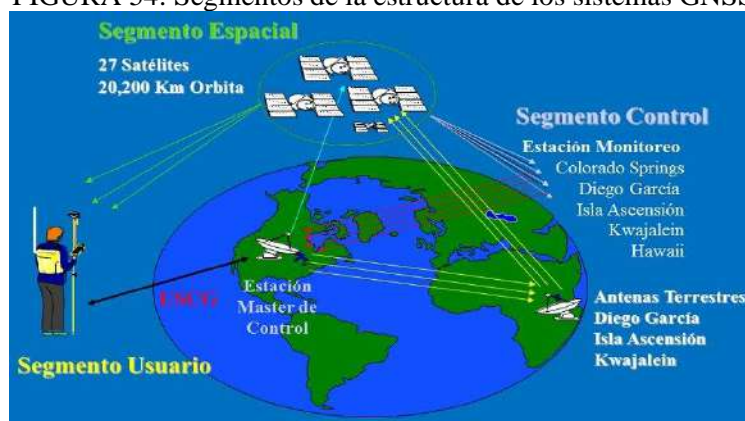
FIGURA 54: Segmentos de la estructura de los sistemas GNSS
