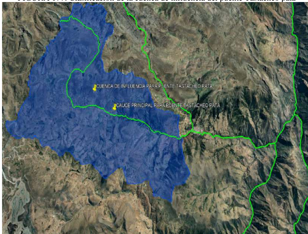
FIGURA 177: Clasificación de la cuenca de influencia del puente Tastacheo pata
