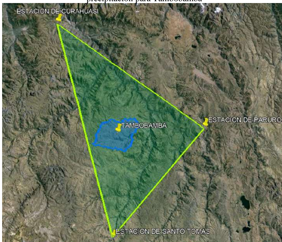
FIGURA 85: Estaciones hidrometeorológicas empleadas para la obtención de los datos de precipitación para Tambobamba
