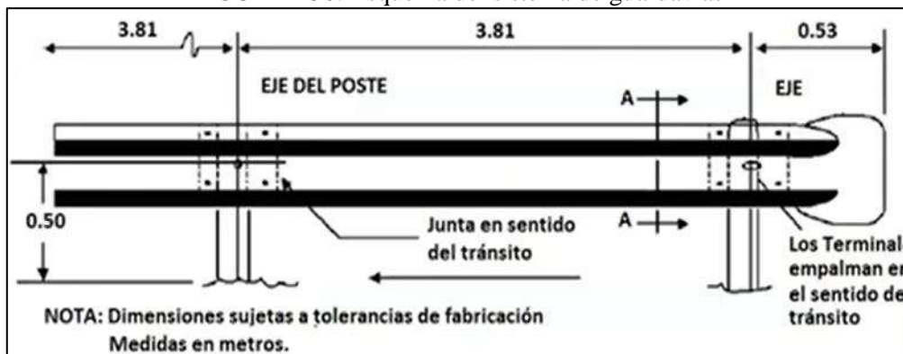
FIGURA 250: Esquema del sistema de guardavías
