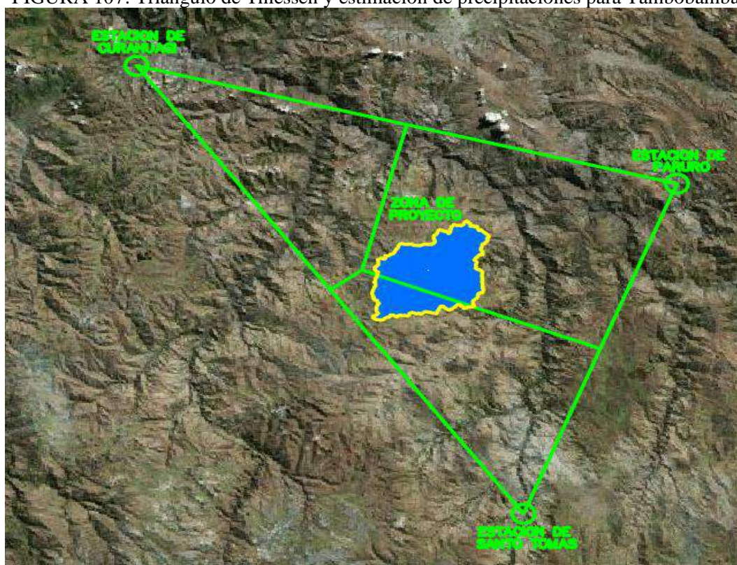
FIGURA 107: Triángulo de Thiessen y estimación de precipitaciones para Tambobamba
