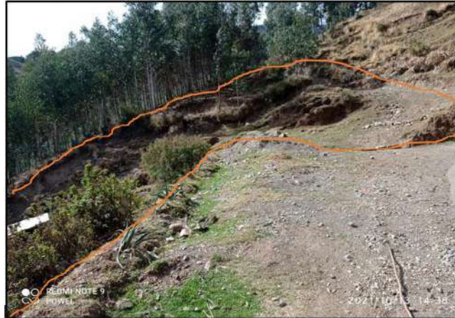
FIGURA 198: Zonas de posibles deslizamientos de poca magnitud producto de altas precipitaciones y pendientes empinadas a moderadas
