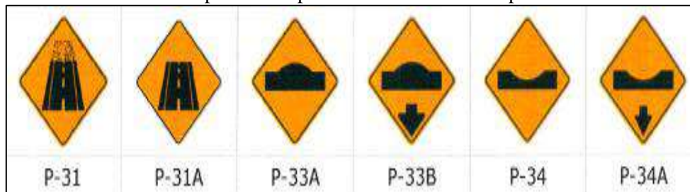
FIGURA 244: Señal preventiva por característica de la superficie de rodadura
