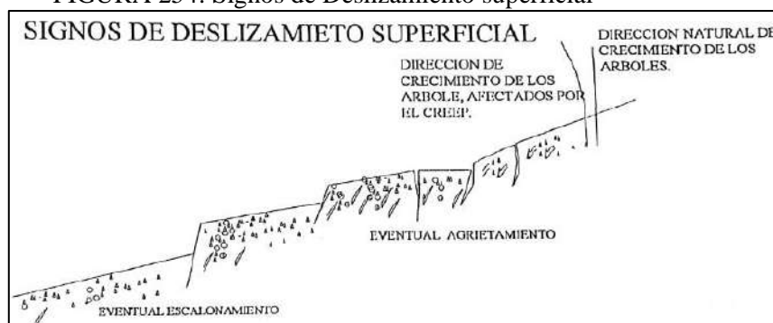
FIGURA 254: Signos de Deslizamiento superficial
