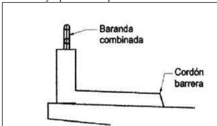
FIGURA 264: Ejemplo de vereda para velocidades menores a 70 km/h
