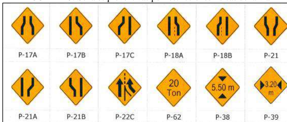
FIGURA 245: Señales preventivas por restricciones físicas de la vía
