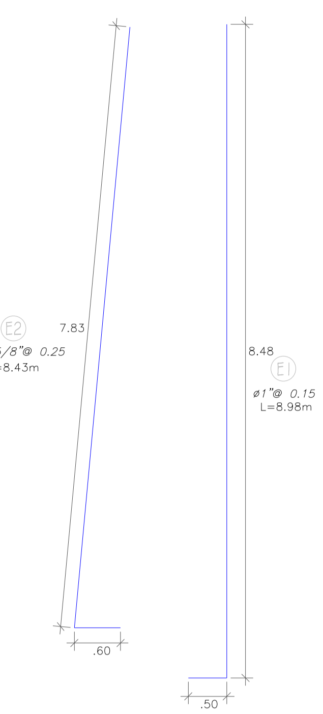
DETALLE DE ARMADURA VERTICAL EN ESTRIBO ESC. 1:50
