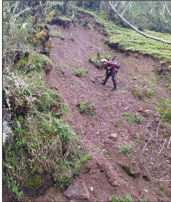
**Fotografía 70.** *Deslizamiento activo con ancho de 20 m y largo de 60 m en la quebrada de huaychaamarca.*
