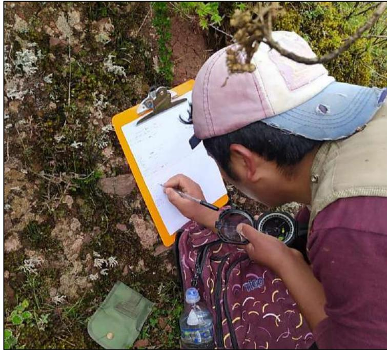
**Fotografía 32.** *Toma de Rumbo y Buzamiento del afloramiento rocoso de areniscas alteradas de la Formación Muñani.*
