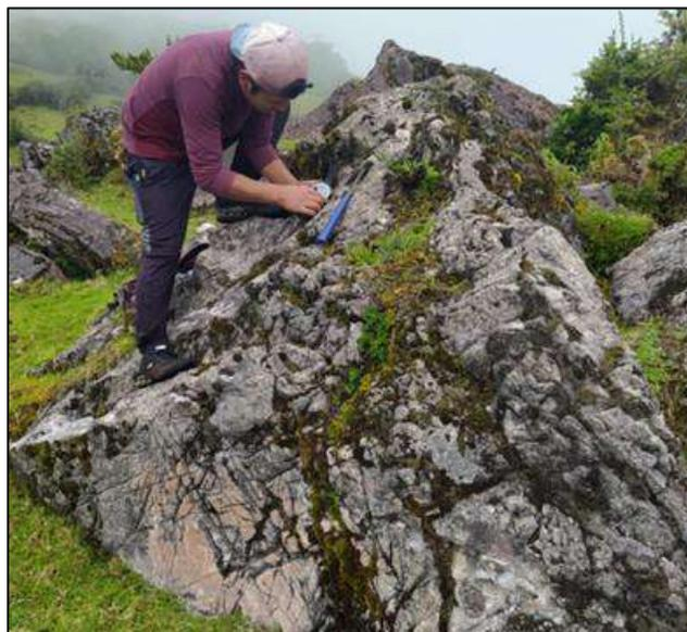
**Fotografía 6.** *Vista de afloramiento rocoso de areniscas cuarzo feldespáticas moderadamente meteorizado y muy fracturadas, ubicadas en la margen izquierda de la quebrada Huaychaumarca.*
