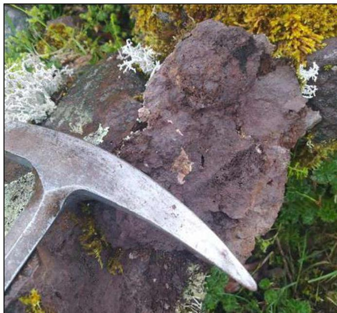
**Fotografía 2.** *Vista de conglomerados moderadamente meteorizado y ubicado en la margen izquierda de la quebrada Huaychaumarca.*
