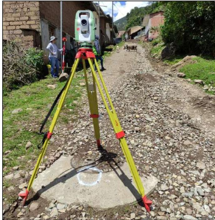
**Fotografía 22.** *Punto de Cambio del levantamiento topográfico BM 03.*
