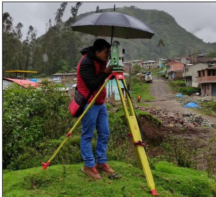
Con la estación inicial ya orientada y la base poligonal claramente definida, se procedió a realizar el levantamiento topográfico general de la zona del proyecto. Se registraron detalles como la ubicación de las carreteras existentes y las características topográficas del terreno
