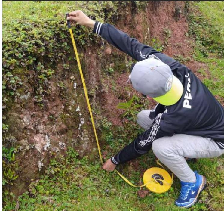
**Fotografía 64.** Escarpa de deslizamiento antiguo de 1.20 m de altura en la quebrada de huaychaumarca.
