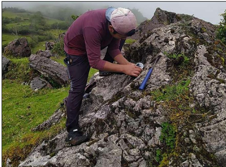
**Fotografía 33.** *Toma de Rumbo y Buzamiento del afloramiento rocoso de calizas alteradas del Grupo Copacabana.*
