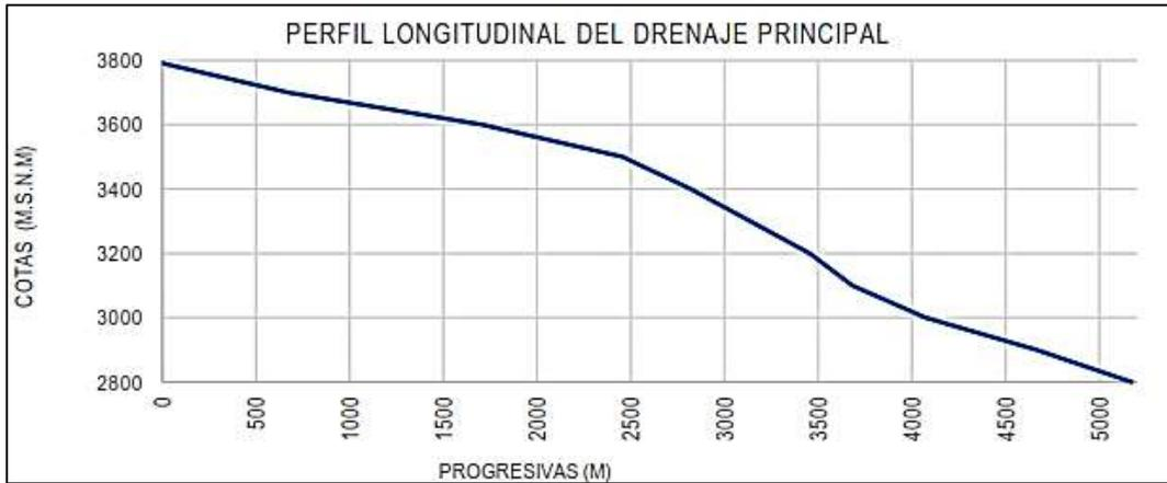
Figura 28. Perfil longitudinal del drenaje de huaychaumarca.
