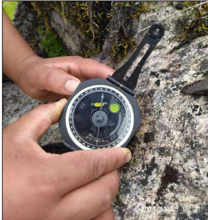
**Fotografía 30.** *Toma de Rumbo y Buzamiento del afloramiento rocoso de calizas alteradas del Grupo Copacabana.*
