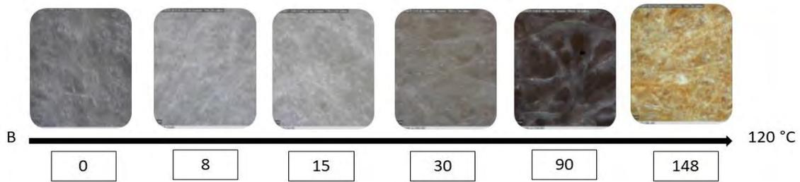
**Figura 32:** Micrografías de la superficie del papel bond inducido a temperatura 120 °C
