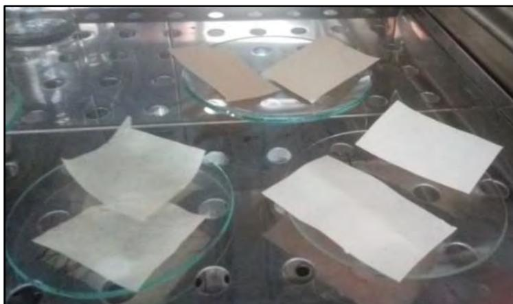
**Figura 21:** Muestras de papel referencial en estufa a temperatura de 120 °C.
