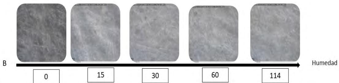
Figura 35: Micrografías de la superficie del papel bond inducido a humedad inicial
