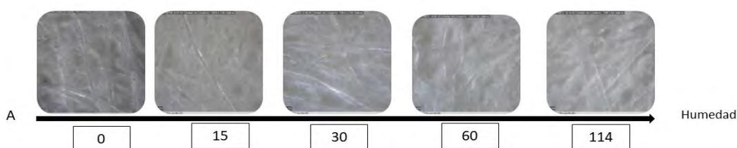
Figura 28: Micrografías de la superficie del papel algodón envejecido por efecto de humedad inicial.
