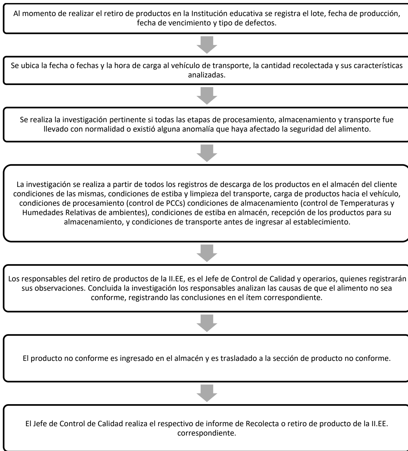
Figura 42 procedimiento de recolecta de producto no conforme
